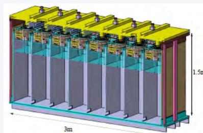
*Les différents segments du détecteur STEREO, observés par des capteurs dans la partie supérieure*
