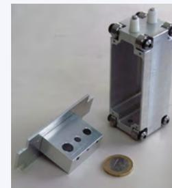
*Élément mobile du système de calibration, servant à déplacer les sources de rayons gamma autour du détecteur*
