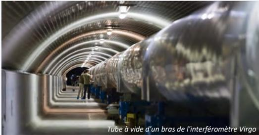
Tube à vide d'un bras de l'interféromètre Virgo
