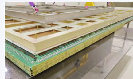
*Détail du plan de détecteur du projet DUNE avec sa structure développée au LAPP*
