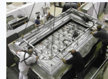
Insertion du système de calibration développé par le LAPP entre le détecteur STEREO et les blindages.
