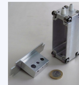
Élément mobile du système de calibration, servant à déplacer les sources de rayons gamma autour du détecteur
